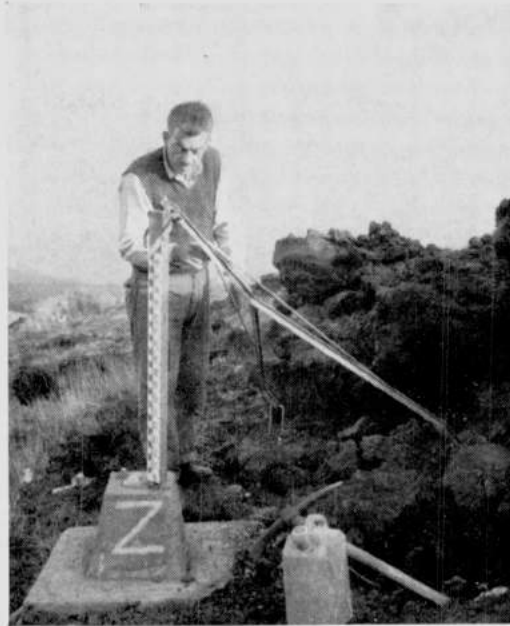
FIG. 4. — Nivellement géométrique: mise en station de la mire sur borne.
