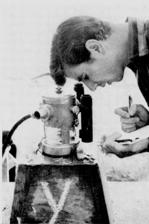
FIG. 5. — Nivellement hydrostatique: pot à eau type IGM/CNV
